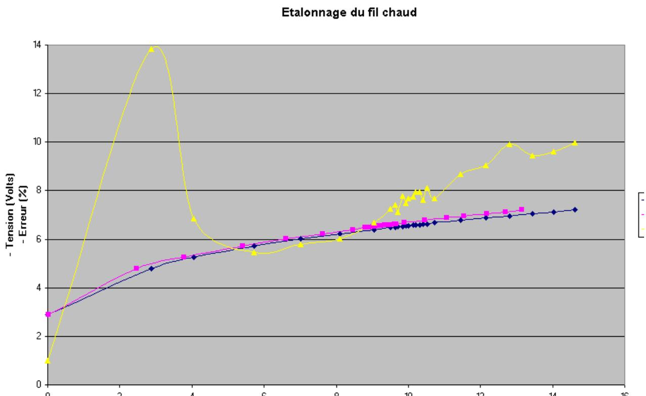
Cependant, pour des vitesses supérieures à 10m/s (dans le cas présent), l'erreur peut être compensée par des compensateurs qui nous permettent de s'abroger des écarts entre la loi de King et le comportement de la sonde. C'est de cette façon que l'on peut étalonner une sonde de façon à adapter sa réponse à la plage d'utilisation que l'on a choisi d'étudier.
