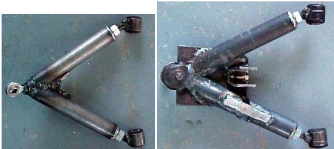
À l'autre extrémité du tube, nous avons emmanché en force des cylindres de quelques centimètres d'épaisseur que nous avons soudés puis taraudés en leur centre. Pour souder les tiges filetées sur les silent-blocks, il nous a fallu ôter la partie en caoutchouc afin de ne pas la brûler lors de la soudure. Nous avons réalisé un marbre de soudage pour respecter les angles. Nous avons ensuite remis les parties en caoutchouc à l'aide de la presse qui se trouve dans le hall de recherche.
